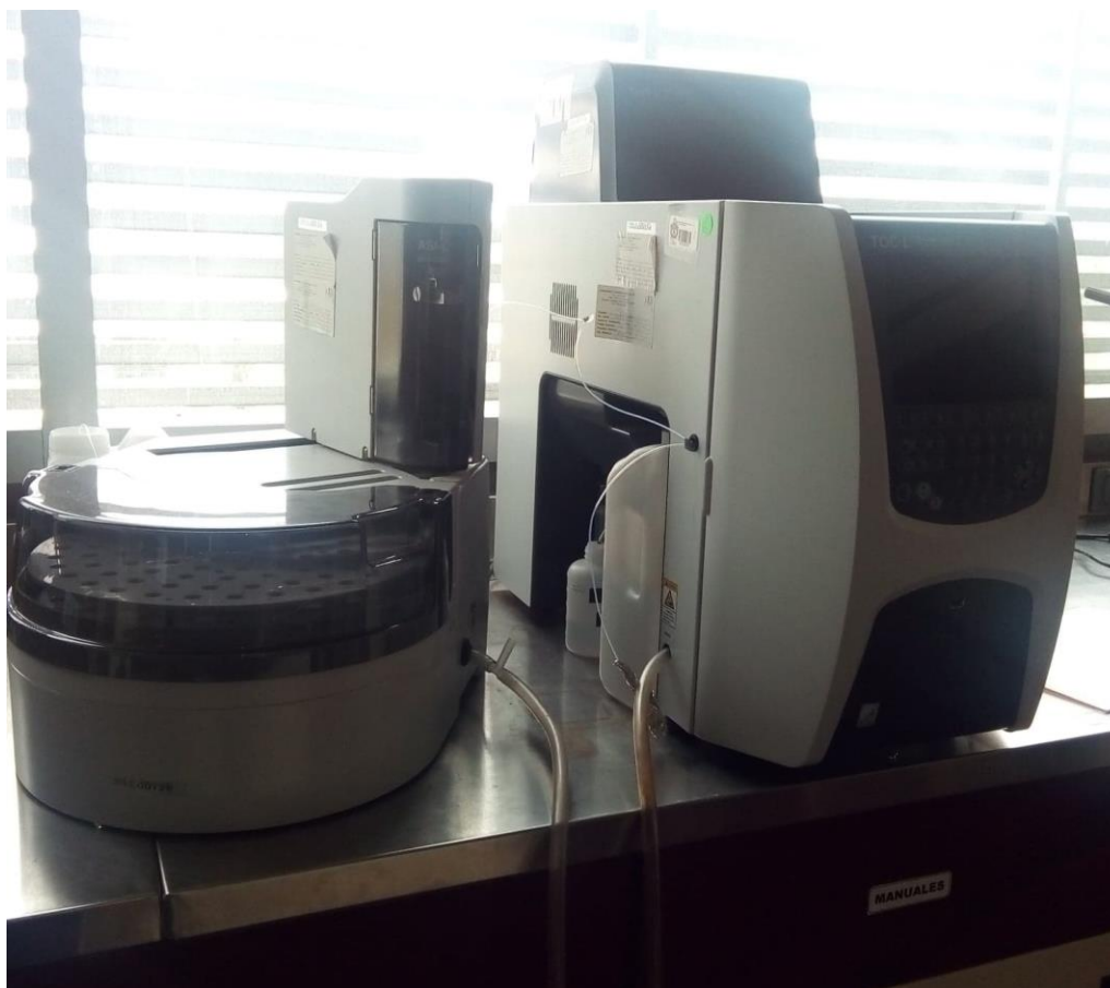
Figura 6. Analizador de Carbono Orgánico Total del Centro Conjunto de Investigación en Química Sustentable UAEM-UNAM.
