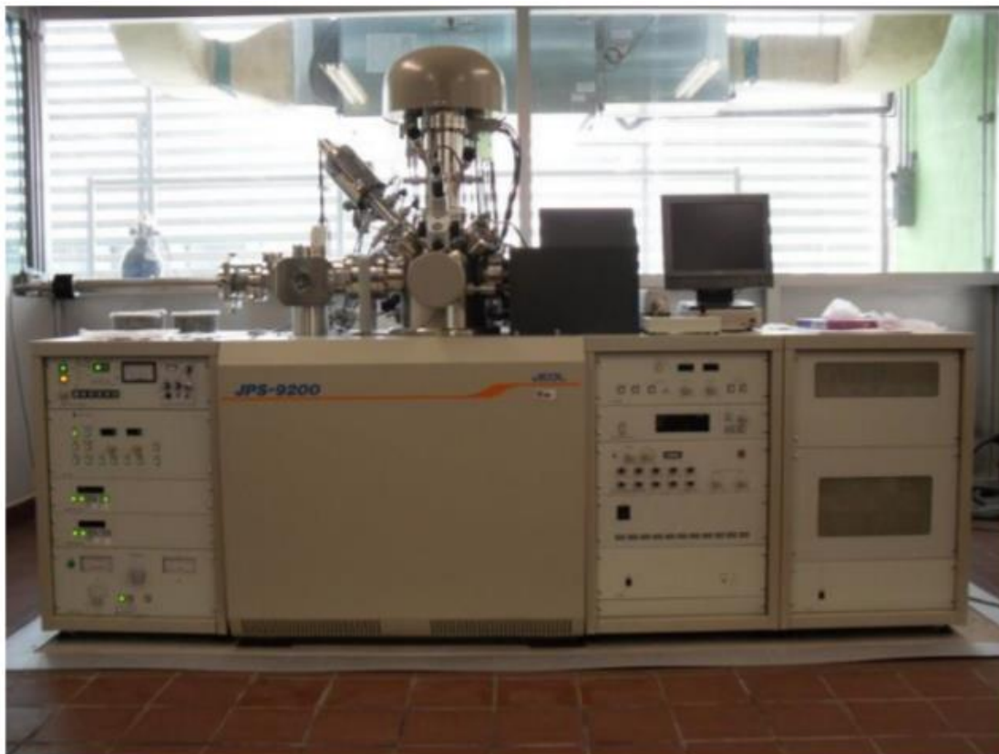
Figura 7. Equipo de Espectroscopia Fotoelectrónica de Rayos X, JEOL JPS-9200 (Equipo del Centro conjunto de Investigación en Química Sustentable UAEM-UNAM)
